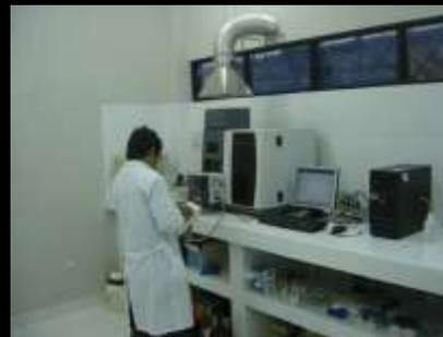
Análisis de calidad de agua mediante espectrofotometría de absorción atómica
